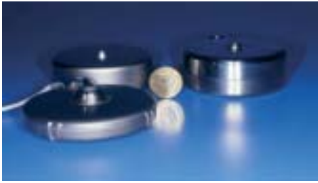
Abb. 1: Gasdruckbetriebene Pumpe im Vordergrund. Zum Vergleich 2 dickere elektronische Pumpen im Hintergrund
